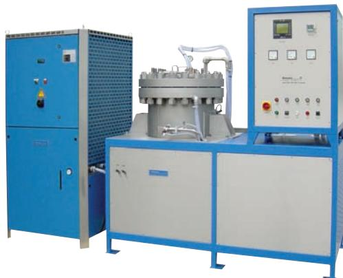
Kammerofen, Hochdruck, wassergekühlter Druckbehälter, PCW Isolation, gas- und vakuumsdicht, Tmax 2200 °C, Pmax bis zu 200 bar.
