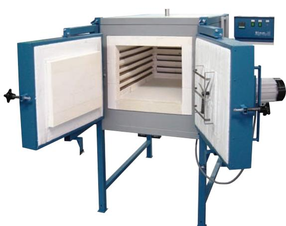
Kammerofen zum Härteln und Anlassen, Stein- und ASW Isolierung, Tmax 1200 °C, 40 - 600 l.
