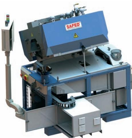
Schüttelherdofen. Wärmebehandlungsanlage im Durchlaufverfahren mit schutzgasdichter Muffel und integriertem Abschreckbehälter. Tmax 950 °C.
