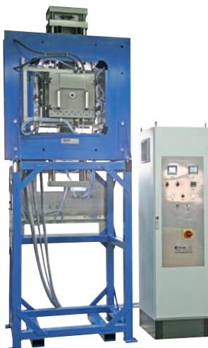
Kammerofen, Hochtemperatur, Al<sub>2</sub>O<sub>3</sub>-PCW und Graphitsolierung, gasdicht, Tmax 1350 °C, 20 L. Zum Erwärmen von Materialproben für Pressversuche.
