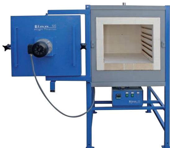
Kammerofen zum Anlassen, Stein- und ASW Isolierung, Tmax 800 °C, 22 - 603 l.
