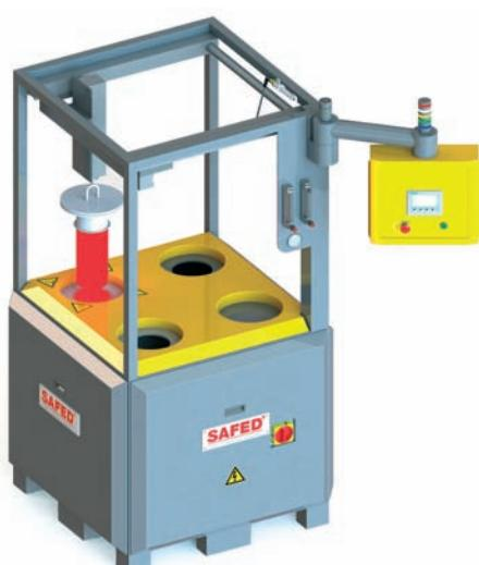
Schachtofen mit Luftumwälzung und Abschreckeinheit; zur thermischen Behandlung mittels Beladekörben unter Schutzgas. Tmax 650 °C.
