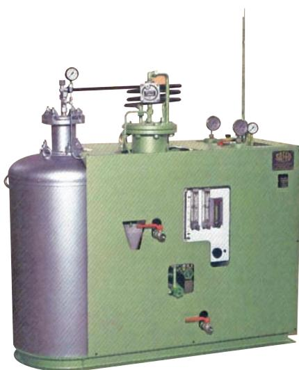
Gasgenerator zur Aufspaltung von Methanol. Bis 35 m<sup>3</sup>/h.
