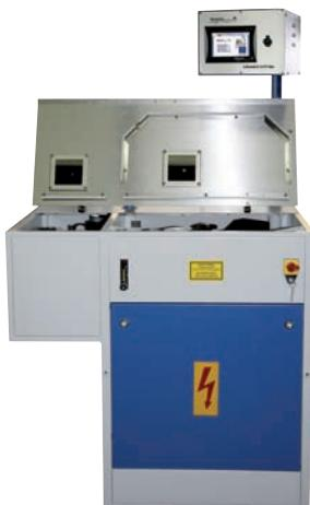
Umschmelz- und Aufschlussanlage für Probenvorbereitung für Spektroskopie (RFA, ICP, AAS, X-Emission) und Schrottrecycling, vakuum- und gasdicht, 3,3 kW.
