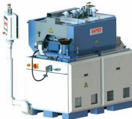
Muffelofen mit Transportband für Wärmebehandlungen unter Schutzgas, mit Ölabschreckbehälter, Tmax 930 °C.
