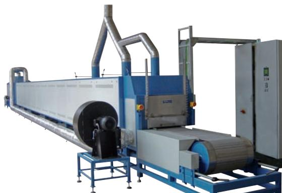
Banddurchlaufofen, Stein-und Aluminiumsilikat-isolation, Tmax 920 °C, 252 kW, 3.500 l.
