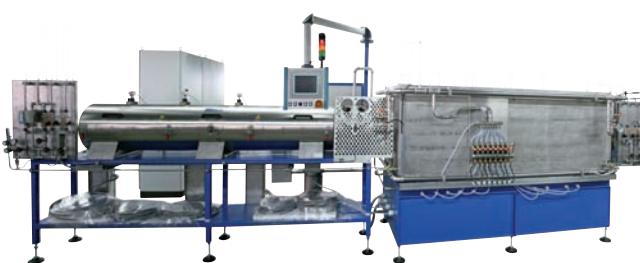
Ofenlinie (Technikumsanlage) zur Carbonfaserherstellung, Tmax bis zu 1600 °C.
