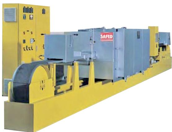
Banddurchlaufofen für Wärmebehandlungen unter Schutzgas. Tmax 1180 °C.
