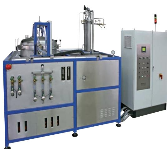
Kaltwandöfen mit metallischem Heizer und Schirmblechpaket als Isolation, gas- und vakuumsicher, Ø 100 - 1000 mm, beheizte Länge 100 - 1000 mm, Tmax 2800 °C..
