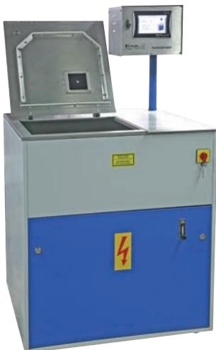
Präzisions-Feinguss-Anlage mit Grobvacuum, gas- und vakuumdicht, 5,0 kW.
