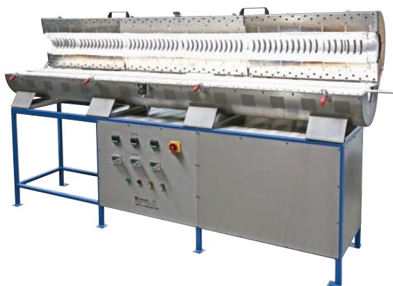
Rohrofen, Hochtemperatur, gasdicht und/oder vakuumdicht, Ø 25 - 150 mm, beheizte Länge 150 - 1000 mm, Tmax 1800 °C.
