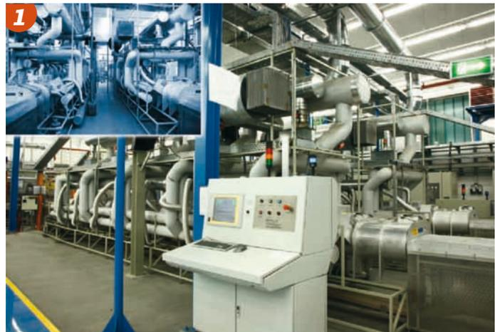
**Bild 1 • Mikrowellen-Banddurchlauf-Trockner für Keramikwaben bis 30 m, 150 kW**
