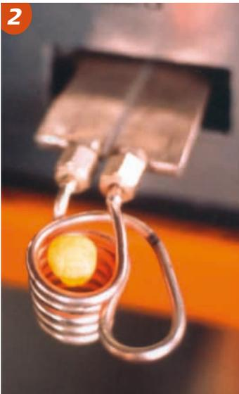
**Bild 2 • Experiment in einem Schwebeschmelzofen während der D1 Mission**
