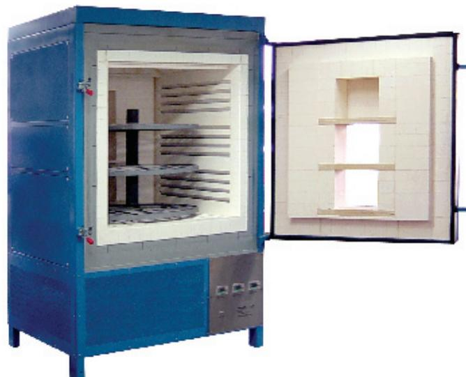
Bild 8: Drehherdofen für Giessformvorerwärmung.
