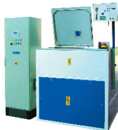
Bild 2: Induktions-Schleudergiessanlage mit 30-kW-Mittelfrequenz-Umrichter.
