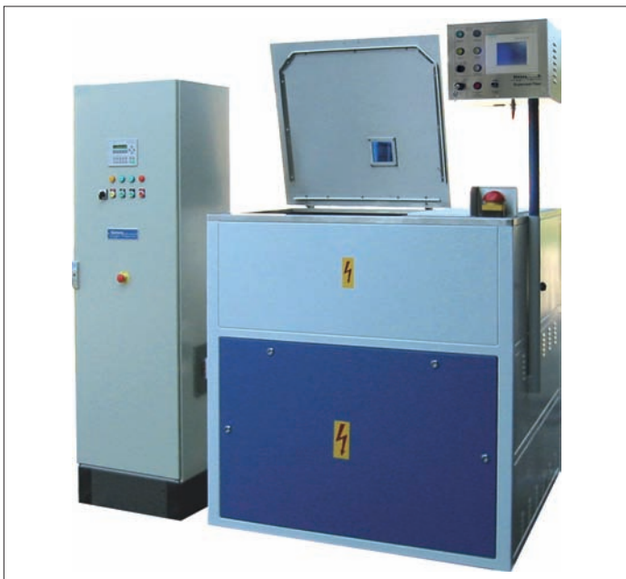
Bild 4: Induktions-Schleudergießanlage Supercast mit Mittelfrequenzinverter
