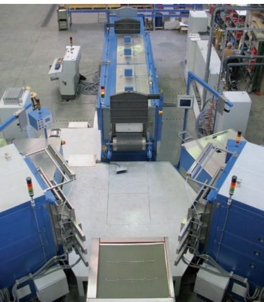
Bild 5: Automatische Gießlinie für Titan- und TiAl-Bauteile
