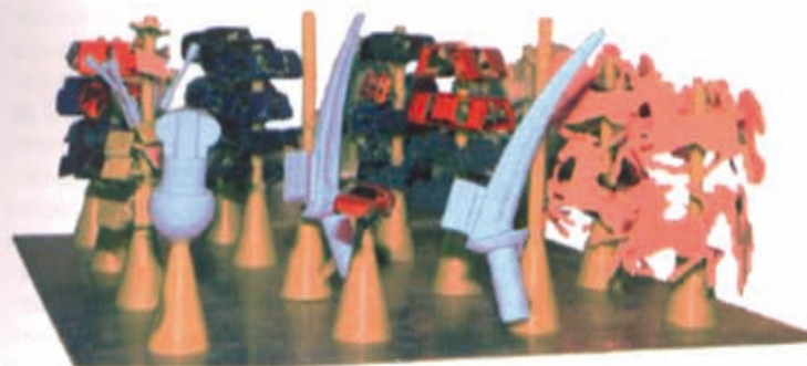
Рис. 6. Выплавляемые модели, собранные в модельные блоки
