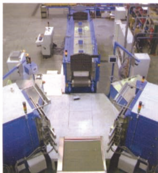
Рис.3. Автоматическая линия для литья титана и титановых сплавов
