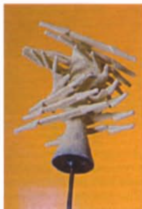
Рис. 7. Модельный блок, покрытый огнеупорной суспензией и зернистым наполнителем
