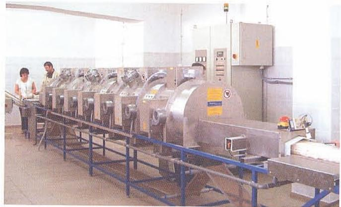
Abb. 2: Mikrowellen-Banddurchlaufofen für Reis, MDBT 21.
