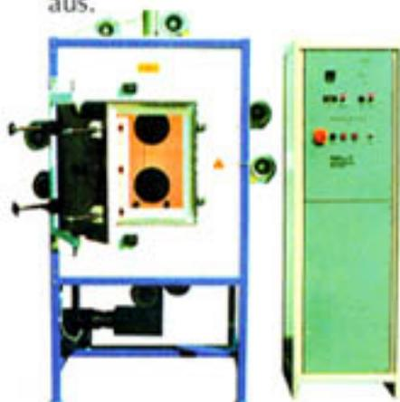
Die elektromagnetischen Mikrowellen können tief in die meisten Materialien eindringen und sie fast vollständig aufheizen. Ein Mikrowellengenerator sendet dazu Strahlung in eine Metallkammer aus, die diese auf das zu erwärmende Material reflektiert. Runde Kammern führen dabei zu einer gleichmäßigeren Feldverteilung als eckige – was offensichtlich in der Küche keine Rolle spielt.
