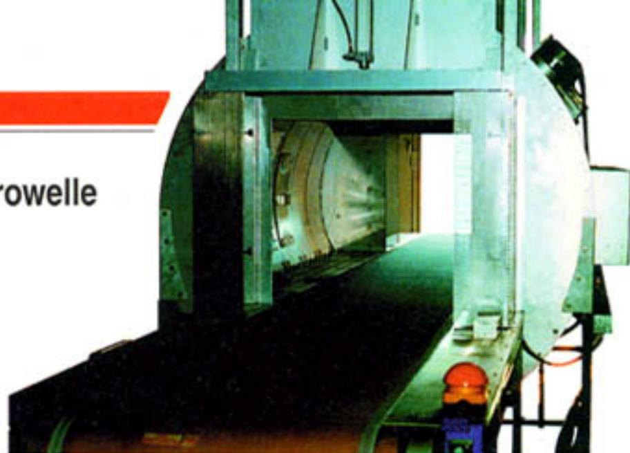
innen heraus erwärmt wird. Daher lassen sich die Katalysatorträger im 20 Meter langen Mikrowellen-Banddurchlaufofen (Bild 2) mit 55 Kilowatt Leistung so schnell trocknen, dass dieser Vorgang in die Produktionslinie integrierbar ist.
