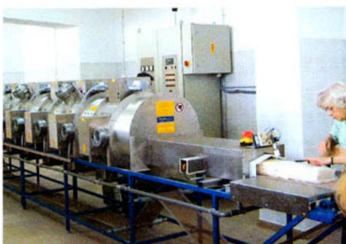
Mikrowellen-Banddurchlauf-Trockner, MDBT 21, Linn High Therm
