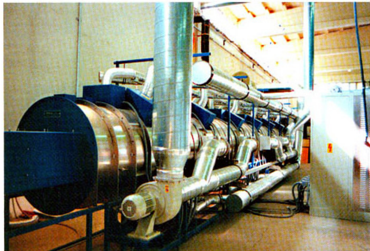
Abb. 2: Mikrowellen-Band-Durchlauf-Erwärmungsanlage, Mikrowellenleistung 60 kW, Länge 15 m
