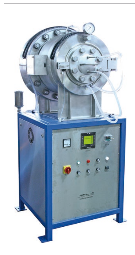
Bild 6: Hochdruckofen bis 1.000 °C mit max. Sauerstoffbetrieb bis 100bar, Molybdän-di-Silizid beheizt für die Entwicklung von Hochtemperatur-Supraleitern (HTSL)
