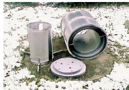
Bild 9: Wolfram-Maschenheizer T_{\text{max}} 2.300\text{ }^{\circ}\text{C} mit Strahlungsschirmen
