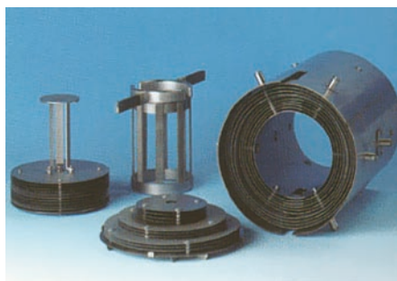
Bild 8: Wolfram-Bandheizer T_{\text{max}} 3.000\text{ }^{\circ}\text{C} mit Strahlungsschirmen und Chargentisch
