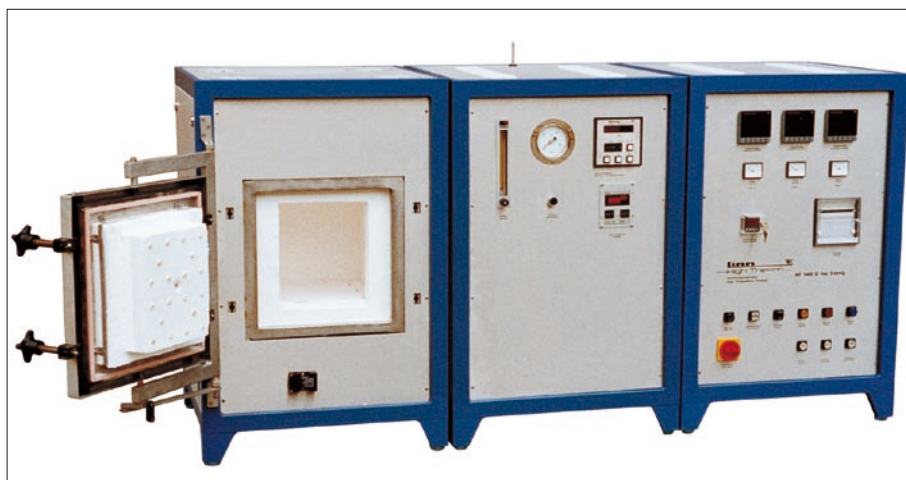
Bild 10: HT 1600 G VAC Schutzgas/Vakuum-Ofen bis 1.600\text{ }^{\circ}\text{C} mit 3-zoniger Regelung
