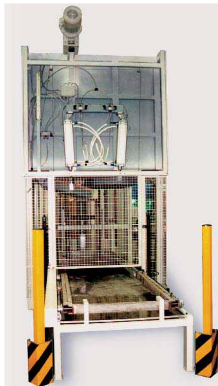
Bild 7: Grundkonzept als Überkopfofen Fig. 7: Basic concept of overhead furnace type
