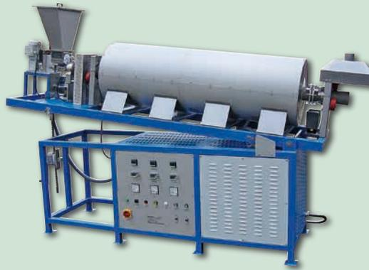
Dieser Drehrohrföfen erlaubt eine Maximaltemperatur von 1200 °C bei einer beheizten Länge von 1500 mm
