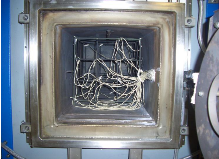
Abb. 2: Symmetrische Anbringung des Hilfsgitters in die Kammer
